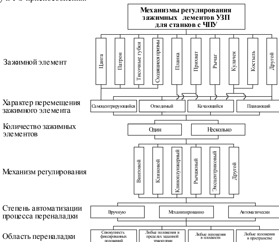
Рис. 3. Классификация механизмов регулирования зажимных элементов переналаживаемых УЗП
