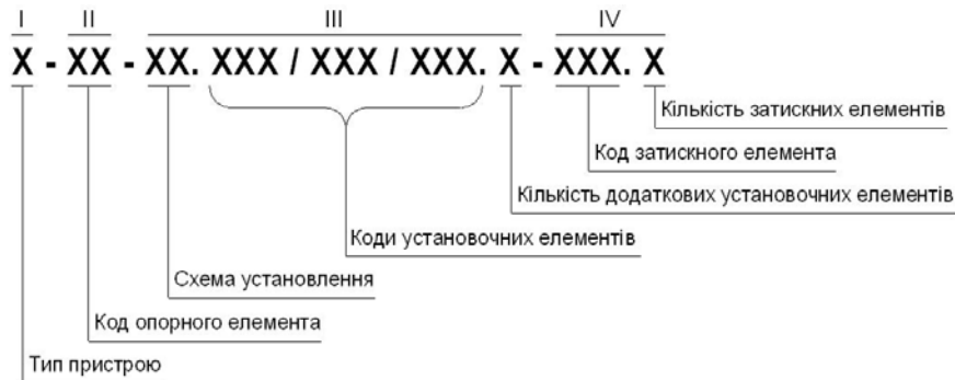
Рис. 2. Структурна формула компоновки верстатного пристрою
