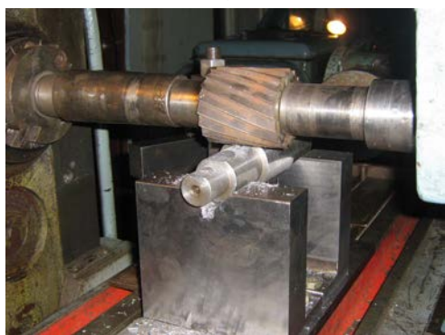
Рис. 11. Фрезерування лиски на горизонтально-фрезерному верстаті мод. 6Р82Г при встановленні заготовок:
