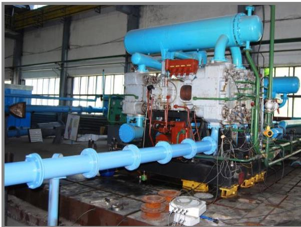
Рисунок 1 – Установка компрессорная 4ВМ2,5-18/9
