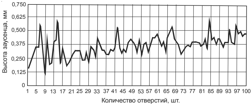
Рис. 2.30. Изменение высоты заусенцев при сверлении отверстий в пакете «углепластик – титановый сплав» с помощью сверла Praso 86 PT [67]
