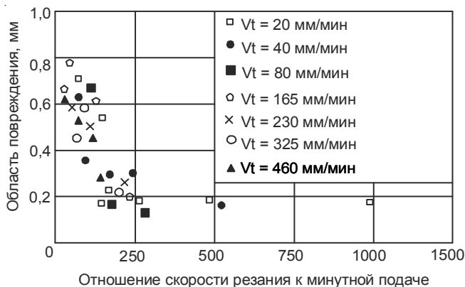
Рис. 5.10. Влияние отношения скорости резания (при V = \text{const} ) к минутной подаче V_f на ширину области повреждения, \Delta D = D_{\text{max}} - D [33]
