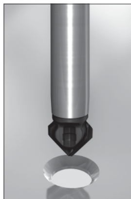
Рис. 6.25. Фреза линии Мультимастер со сменной головкой MM HDF компании ISCAR
