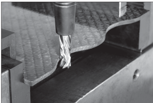
Рис. 6.9. Монолитная фреза EPX компании ISCAR с алмазным покрытием для обработки углепластиков с большой шириной среза
