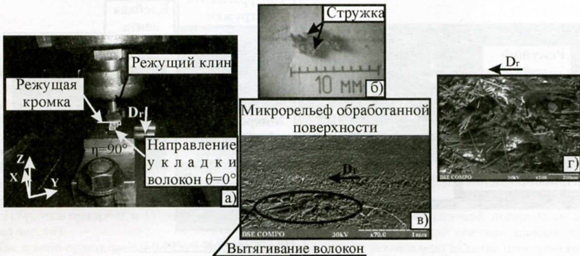
Рис. 9. Иллюстрация схемы обработки образца и поверхностных дефектов при \theta = 0^\circ и \eta = 90^\circ
