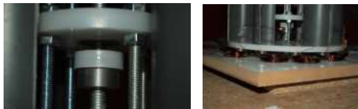
Рисунок 3 – Собранный магнитный подвес
