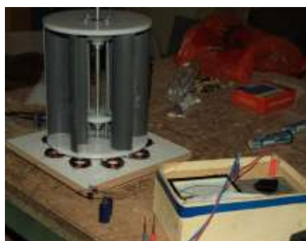
Рисунок 5 – Ветрогенератор с вертикальной осью вращения ротора и магнитным подвесом
