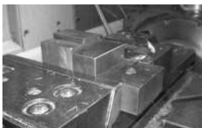
Рисунок 1 – Расположение вибродатчиков AP 2019 (по осям z и x ) на призматическом образце (слева) и настройка на выполнение рабочего хода фрезерования (справа) на станке мод. 500 V/5.
