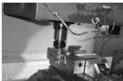
Рисунок 1 – Расположение вибродатчиков AP 2019 (по осям z и x ) на призматическом образце (слева) и настройка на выполнение рабочего хода фрезерования (справа) на станке мод. 500 V/5.
