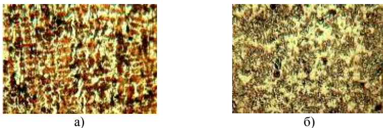
Рис. 3. Структури сплавів матриці планування при мінімальному та максимальному вмісті елементів, х300: а - 2,5%С, 1%Ті, 0,02%N; б - 3,5%С, 4%Ті, 0,04%N.
