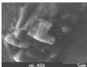
Рис. 12. Виділення вторинної фази на карбонітриді титану в сплаві E350T4ACG при охолодженні зі швидкістю 1,3^{\circ}\text{C}/\text{c} , \times 6410 .
