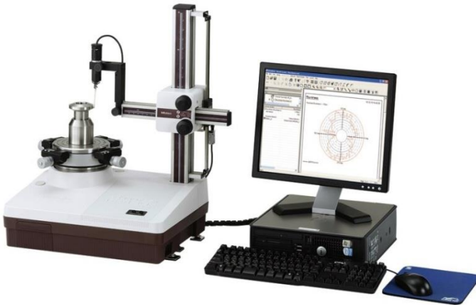
Рисунок 2.26 – Пристрій для вимірювання відхилень круглості Roundtest RA-120P (Mitutoyo, Японія)
