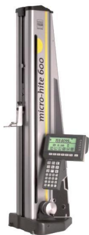
Рисунок 2.23 – Цифрові: а – висотомір micro-hite 600, б – глибиномір Micromaster (TESA, Швейцарія)
