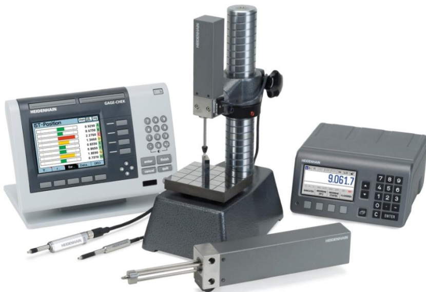
Рисунок 2.18 – Система контролю мір довжини Length Gauges (Heidenhain, Німеччина)
