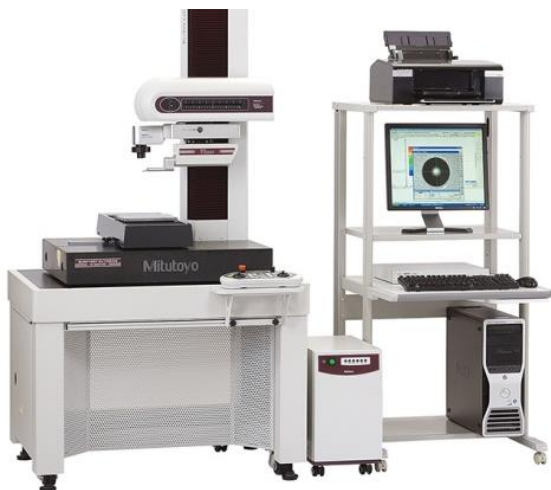
Рисунок 2.27 – Пристрій для вимірювання відхилень поверхонь Surftest Extreme SV-3000CNC (Mitutoyo, Японія)
