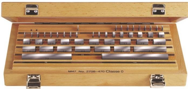
Рисунок 2.3 – Плоскопаралельні кінцеві міри довжини Gauge Blocks Set M47 (TESA, Швейцарія)
