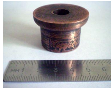
Рисунок 1 – Заготовка деталі «втулка з буртом» після штампування: а – креслення, б – фотографія
