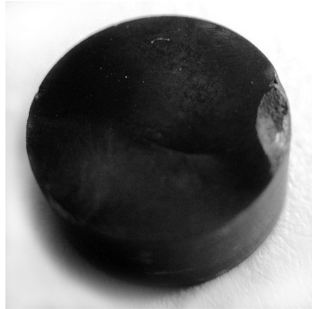
Рис. 3. Повреждение режущей кромки пластины
