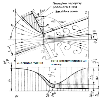
Рисунок 1.19 – Схема руху рідини у регульованому дроселі
