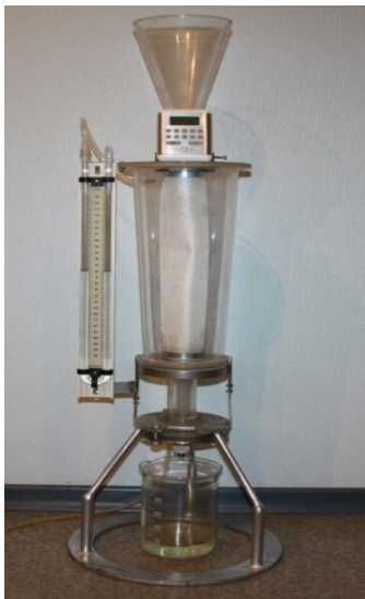
Рис. 1. Фото та схема базової моделі інтраторакального шлунка та пілоричного каналу: Q1– потік рідини через інтраторакальний шлунок; Q2– потік рідини через пілоричний канал, Q1 = Q2 ; D – діаметр ІТШ; d– діаметр пілоричного каналу; V – об'єм уведеної рідини.
