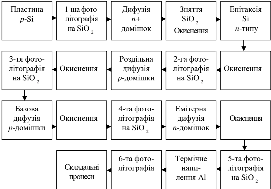
Рисунок 2.6 – Схема технологічного процесу виготовлення ІМС епітаксійно-планарної структури із прихованим шаром
