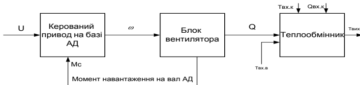
Рисунок 1 – Структурна схема моделі охолоджувача установки
