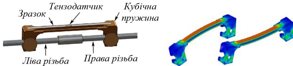
Рис 1.5. Зовнішній вигляд пристрою для деформації. Із роботи [50]
