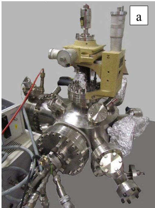
Рис. 2.2. Зовнішній вигляд надвисоковакуумної камери (а) та випарника для конденсації Fe і Pt (б)
