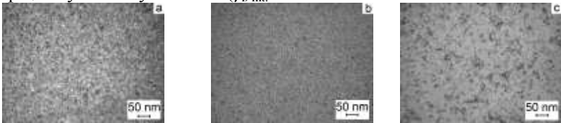
Рисунок 1 – Мікроструктура плівок різного фазового складу: а – ГЦК т.р.(Au); б – перехідна область і в – ОЦК т.р.(Fe)
