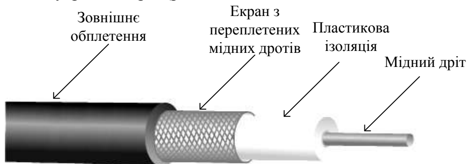
Рис. 2.3.1. Структура коаксіального кабелю
