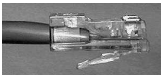
Рис. 3.6.4. Правильне з'єднання кабелю UTP з конектором RJ-45
