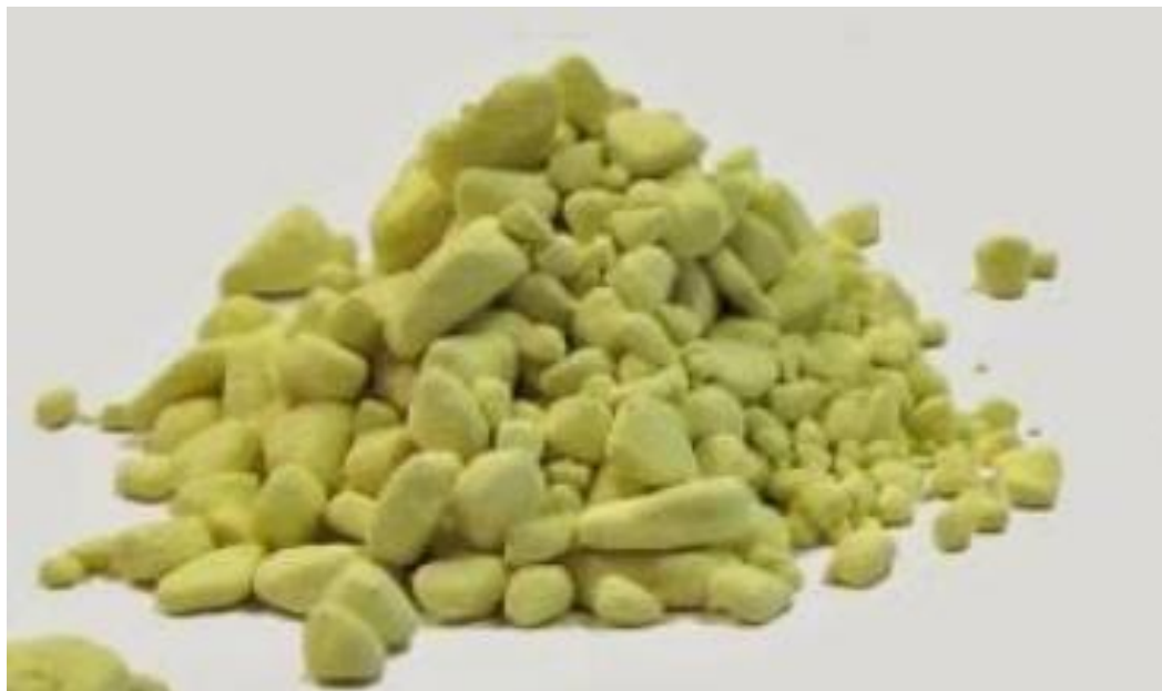
Рисунок 5.4 – Біосірка: загальний вигляд після сепарації
