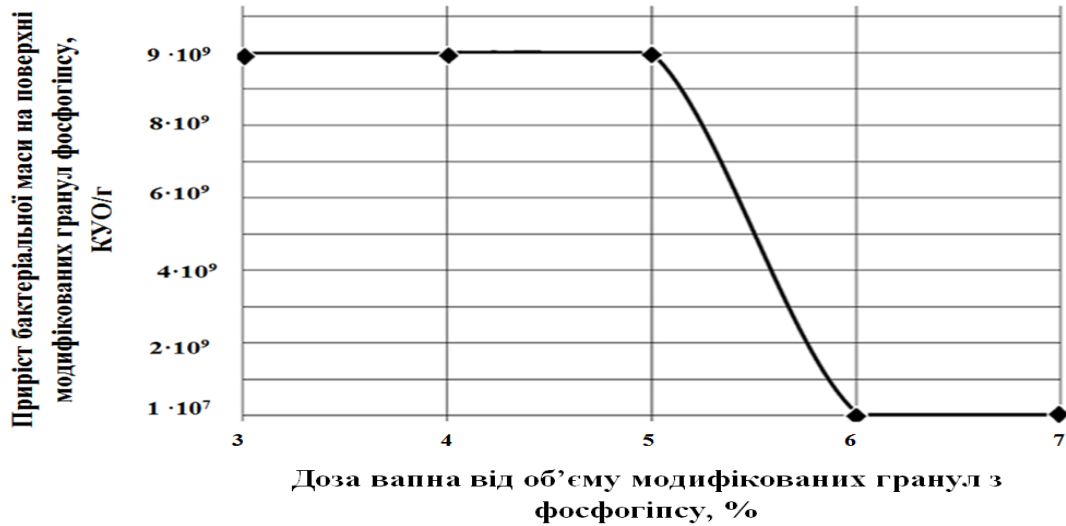
Рисунок 3.6 – Залежність приросту бактеріальної маси від дози добавки вапна при отриманні модифікованих гранул фосфогіпсу
