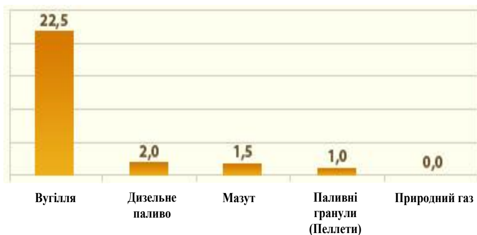
Рисунок 6.17 – Вміст вуглекислого газу у викидах при спалюванні різних видів палива, %
