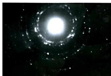
Рис. 3 – Электроннограмма участка пленки, обогащенного индием
