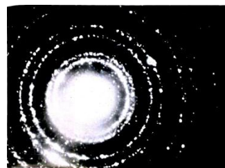
Рис. 4 – Электроннограмма участка пленки, обогащенного германием
