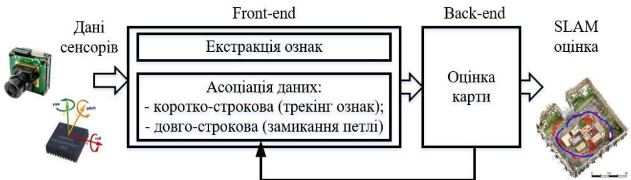
Рисунок 1.22 – Архітектура типової SLAM-системи
