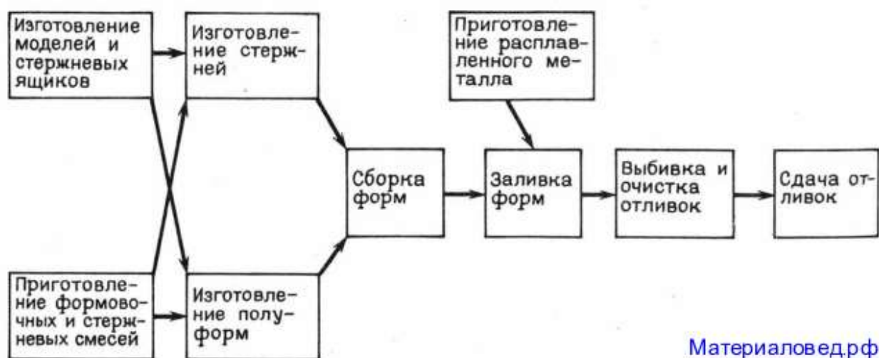
Рисунок 6.2 - Схема технологического процесса изготовления виливків в піщаних формах
