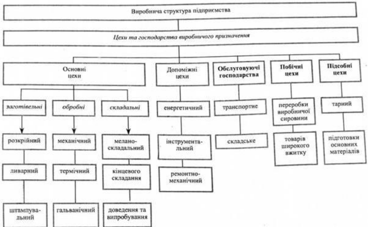
Рисунок 10.1 – Схема виробничої структури машинобудівного підприємства
