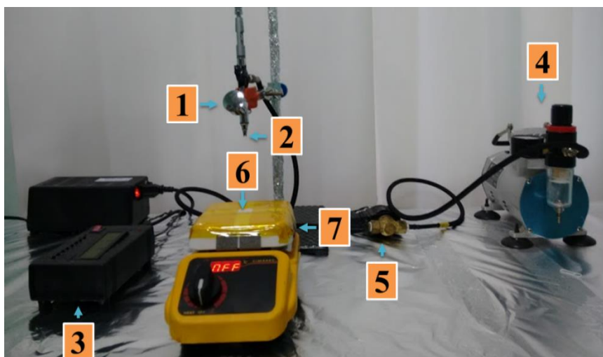
Рис. 1.4. Експериментальна установка спреї-піролізного нанесення плівок [31]:
