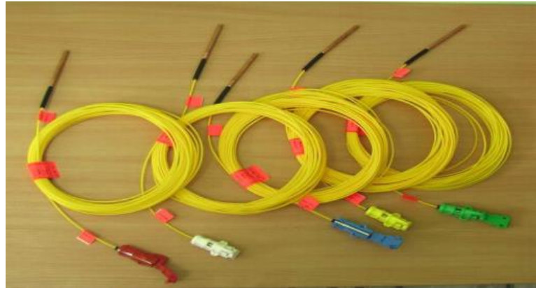
Рисунок 1.14 – Елемент неелектричної системи ініціювання «Пріма-Ера»-СД [179]
