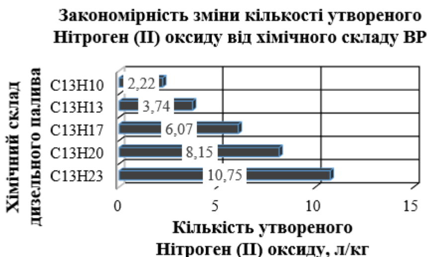
Рисунок 5.1 – Закономірність зміни кількості утвореного Нітроген (II) оксиду під час вибуху від хімічного складу дизельного палива у вибуховій речовині
