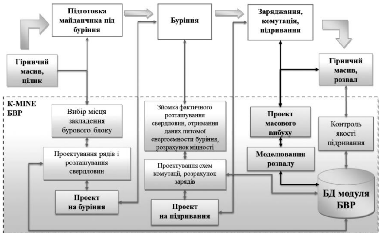
Рисунок 1.11 – Структурна схема роботи системи проектування і управління буровибуховими роботами із застосуванням K-MINE [128]
