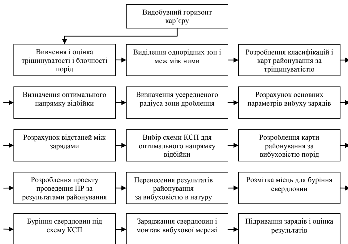
Рисунок 6.2 – Алгоритм послідовності виконання операцій під час проектування параметрів вибухів під схеми КСП на основі карт районування кар'єрів за вибуховістю порід
