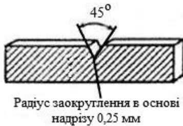
Рисунок 6.6 – Зразок для вимірювання ударної міцності
