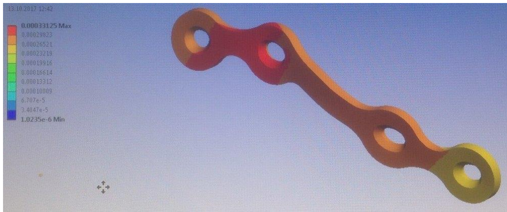
Рисунок 3.4.5 – Деформація пластини збільшена в 100 разів
