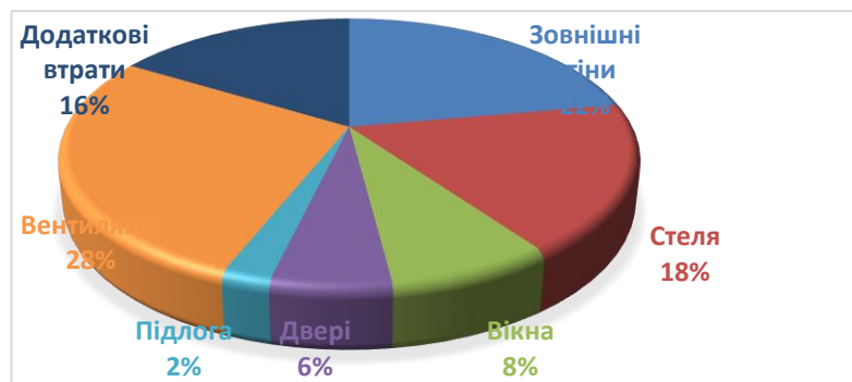
Рисунок 2.2 – Розподіл тепловтрат корпусу Б
