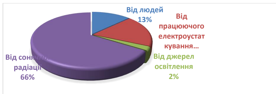
Рисунок 2.3 – Розподіл теплонадходжень в корпусі А
