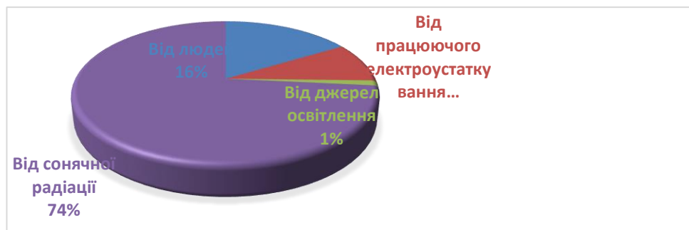
Рисунок 2.4 – Розподіл теплонадходжень в корпусі Б
