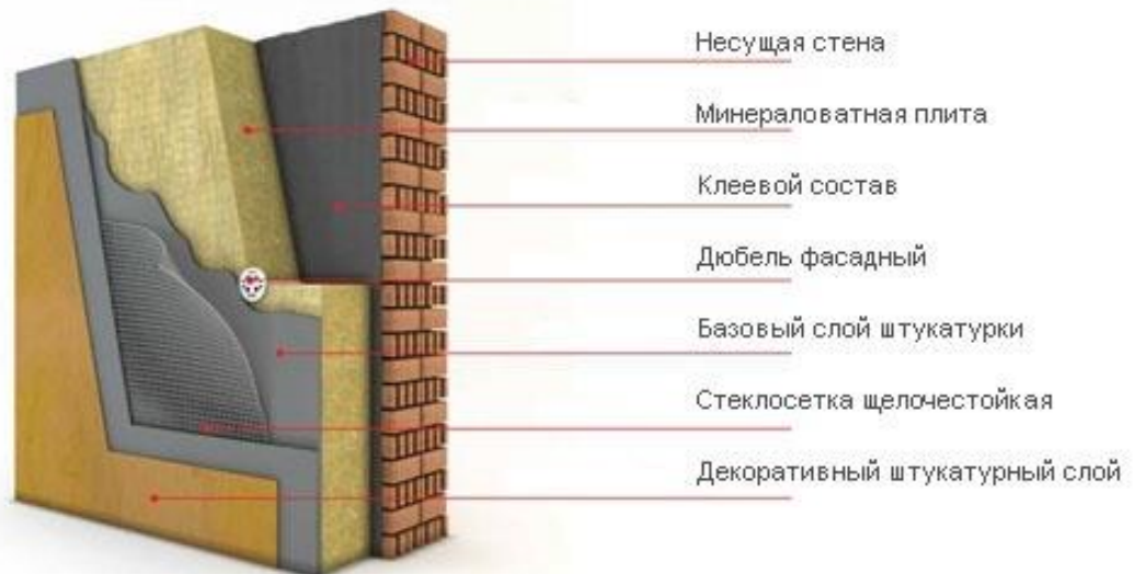
Рисунок 3.1- Схема утепления стін
