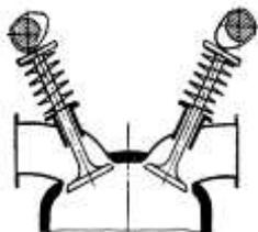
Основная разница между впускными и выпускными клапанами состоит в различных рабочих температурах. Выпускные клапаны находятся под постоянным воздействием крайне разрушительных газов, а температуры часто превышают рубеж  $760^{\circ}\text{C}$ . Впускные же клапаны постоянно охлаждаются потоками воздушно-топливной смеси и не разогреваются до таких
