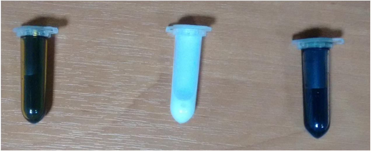
Рисунок 2.2 - Щойно синтезований розчин НЧ Ag, CZTS і ZnO після заміщення диспергованих поверхнево-активних речовин
