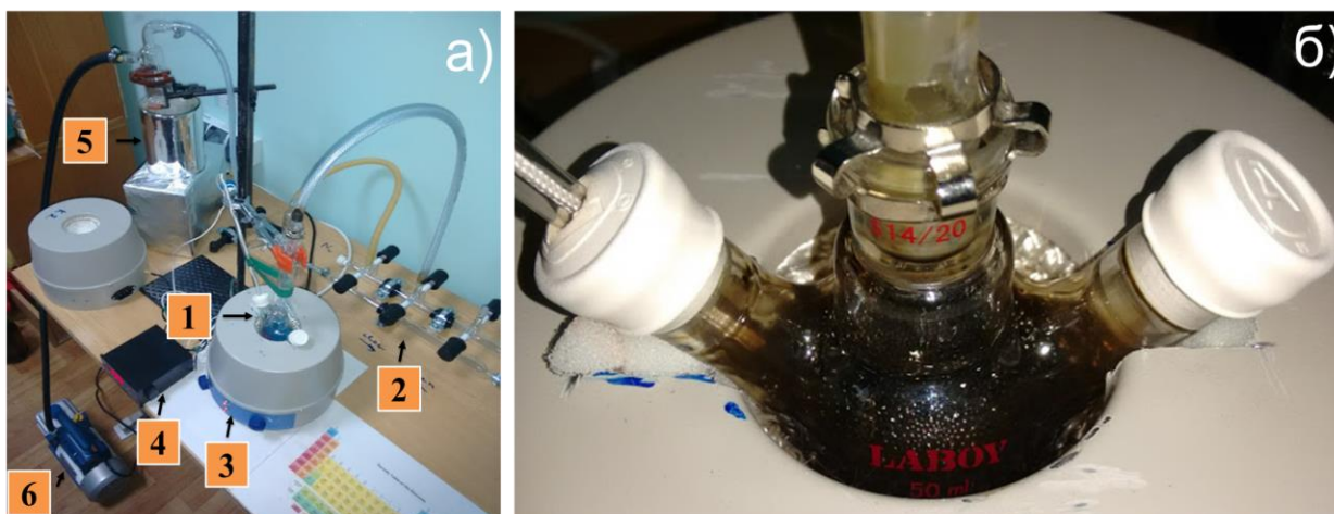
Рисунок 2.1 - Вигляд установки для колоїдного синтезу НЧ (а), що складається з реакційної системи (1), лінії Шленка (2), нагрівача колби і змішувача (3), блоку регулювання температури (4), вакуумної пастки в колбі Дьюара, заповненої рідким азотом (5) і форвакуумного насосу (6); вигляд реакційної системи (б) з синтезованими наночастинками CZTS
