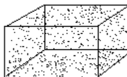
Рисунок 3.3 – Структура двокомпонентного матеріалу, на основі політетрафторети-лену, армованого вуглецевими волокнами Рисунок 3.4 – Структура двокомпонентного матеріалу, на основі політетрафторети-лену, армованого дисперсними частинками
