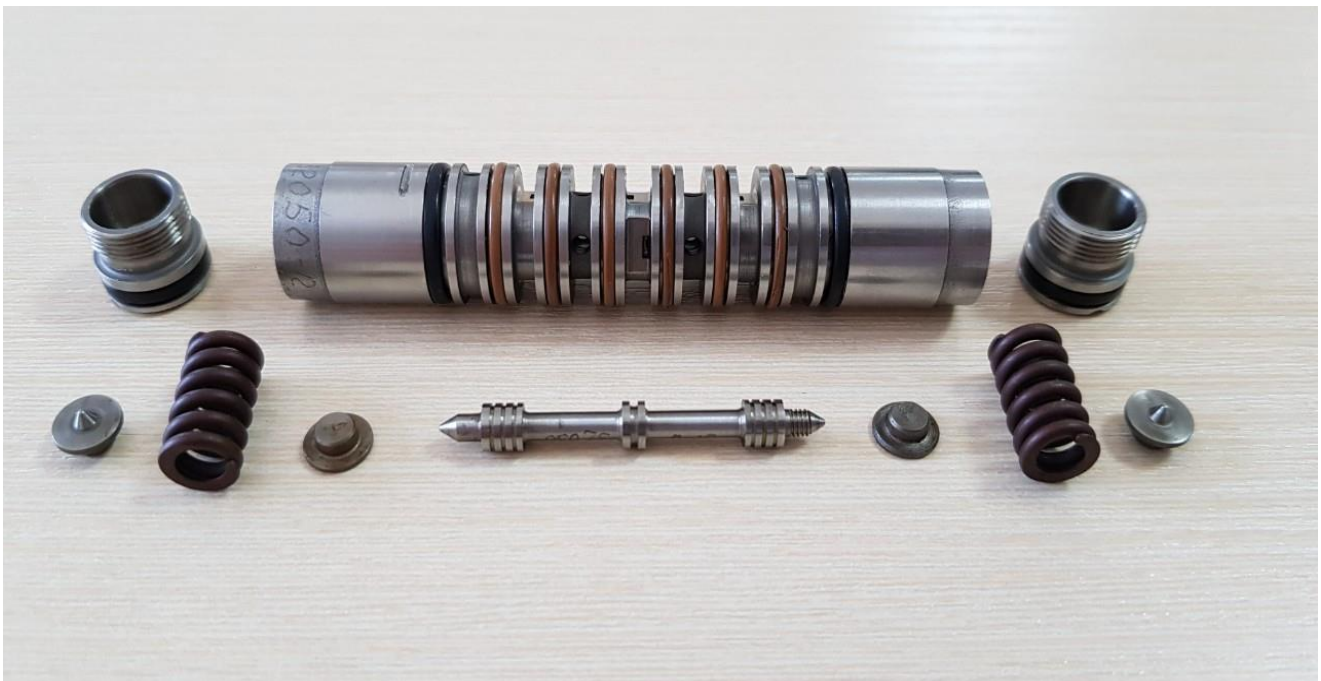
Рисунок - 13. Дільник потоку з додатковим зворотним зв'язком по перепаду тиску в міждросельній камері
