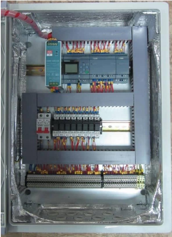
Рисунок - 14. Щит (панель) приладів для фіксації показників робочого процесу дільника потоку.
