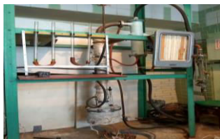
Рисунок 1 – Експериментальна установка для розділення ЕАФ
