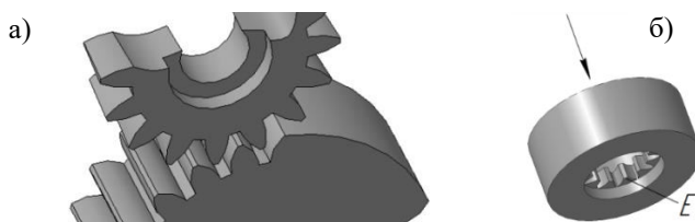
Рисунок 1 – Схеми роботи довбачі та зубодовбальної голівки
