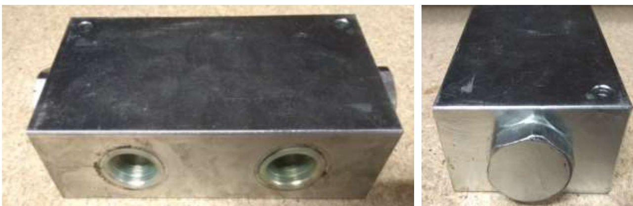
Рисунок 5.5 – Дільник потоку з додатковим зворотним зв'язком по перепаду тиску в міжросельній камері
