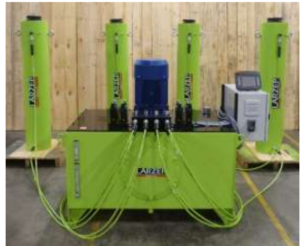
Рисунок 1.22 – Підіймальна система з синхронізованими гідравлічними циліндрами Larzer Hydraulics серії HAS Series.
