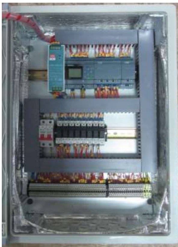
Рисунок 5.8 – Щит (панель) приладів для фіксації показників робочого процесу дільника потоку.
