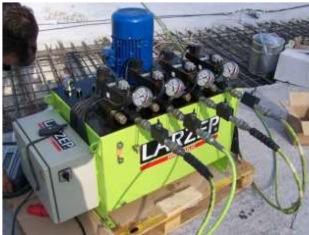
Рисунок 1.22 – Підіймальна система з синхронізованими гідравлічними циліндрами Larzer Hydraulics серії HAS Series.
