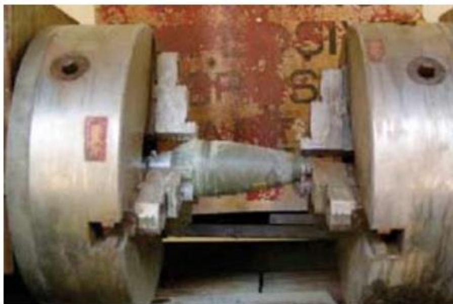
Рисунок 1.8 – Токарний верстат для різання мінометної міни калібру 81 мм
