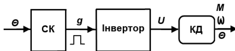
Рисунок 3.1 – Структурна схема крокового електроприводу осі X
