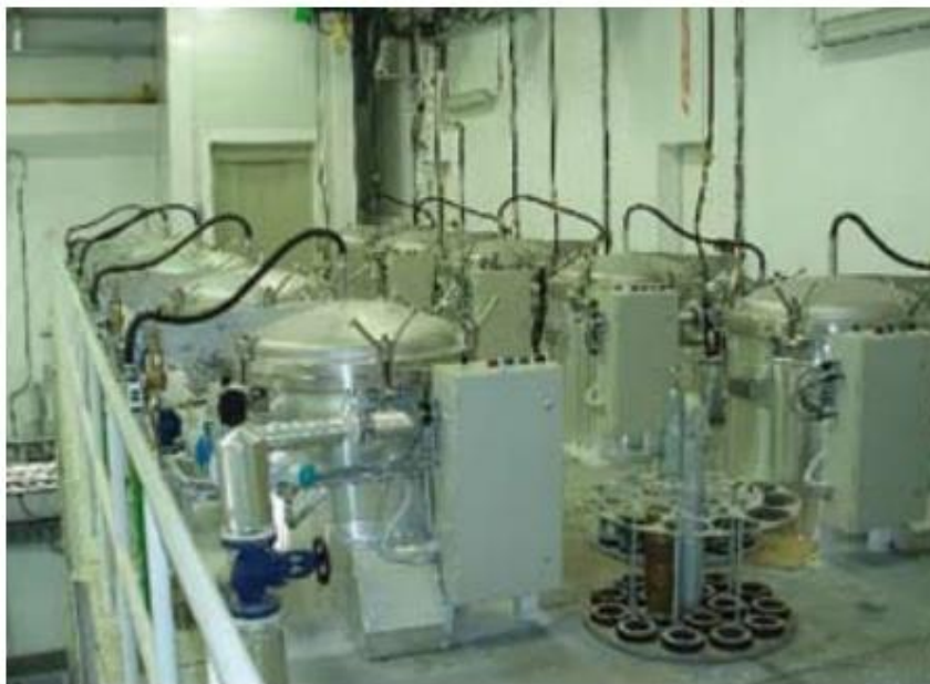
Рисунок 1.11 – Виплавлення TNT в автоклавах на заводі по утилізації боєприпасів в Анкарі (фото NAMSA)
