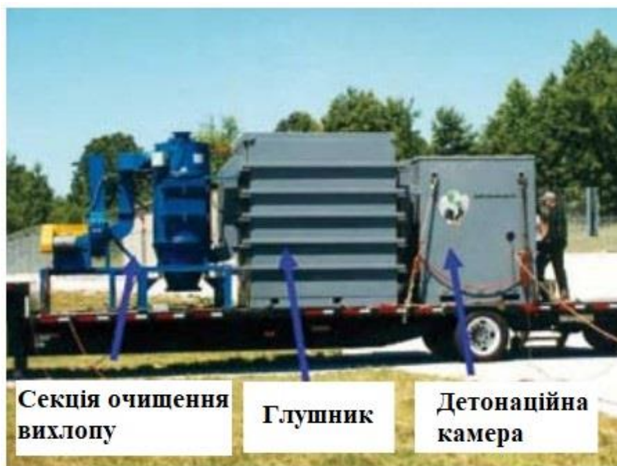
Рисунок 1.7 – Пересувний варіант детонаційної камери, обладнаної глушником і секцією очищення вихлопу
