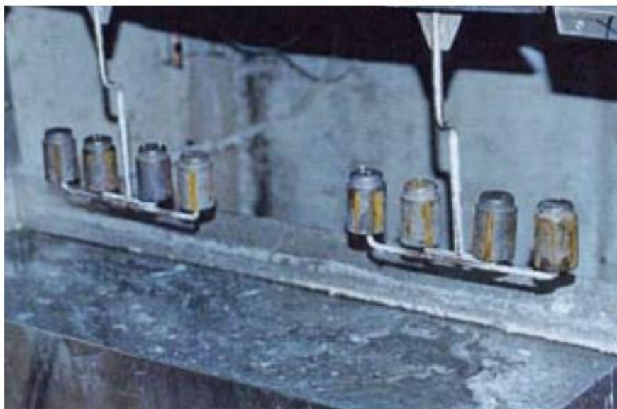
Рисунок 1.10 – Установка для вакуумного розламування снарядів на заводі "Алсетекс", Франція (фото NAMSA)
