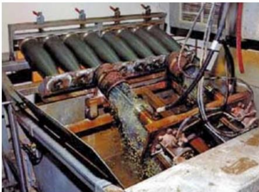
Рисунок 1.12 – Вимивання вибухівки струменем води з снарядів калібру 155 мм
