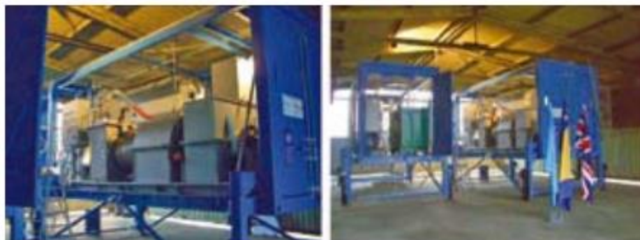
Рисунок 1.3 – Пересувна система знищення боєприпасів на контейнерній платформі, що застосовується відділенням ПРООН в Боснії
