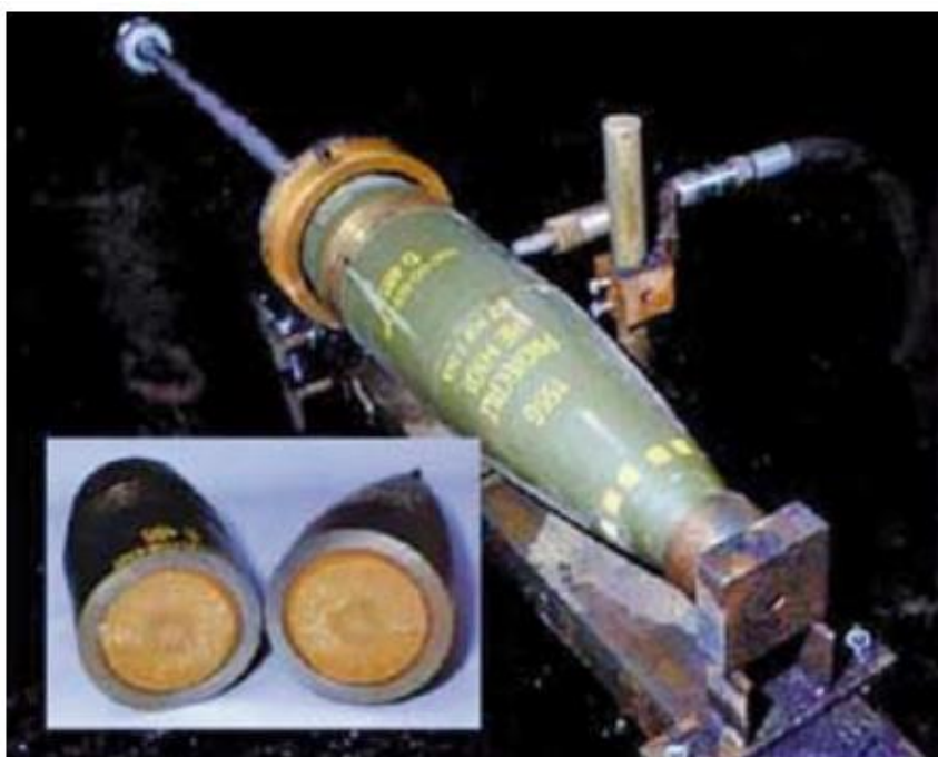
Рисунок 1.9 – Устаткування для гідроабразивного різання. На вставці показаний розрізаний снаряд калібру 155 мм
