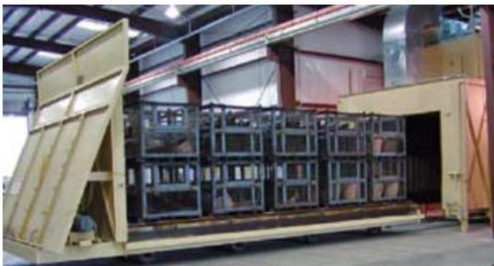
Рисунок 1.6 – Установа високотемпературної газової дезактивації.
