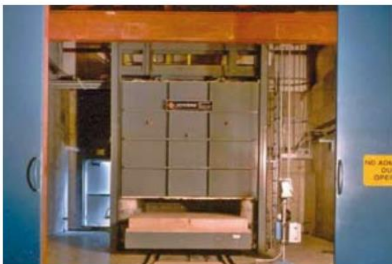
Рисунок 1.5 – Вид печі з висувним піддоном в напіввідкритому стані
