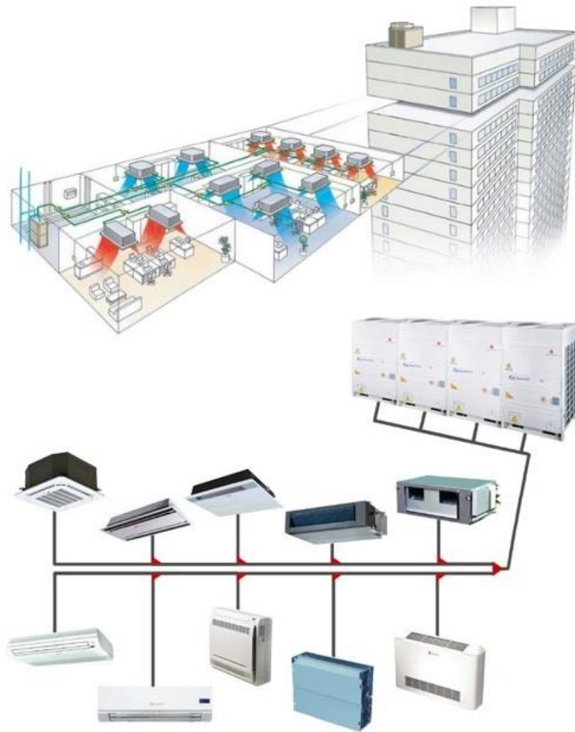
Рисунок 4.4 – Система чиллер- фанкойл.
