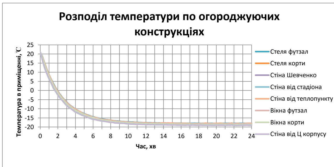
Рисунок 3.19 – Розподіл температури по огорожуючих конструкціях
