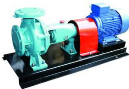
Рисунок 4 – Конструкція насоса типу К згідно ISO 2858
