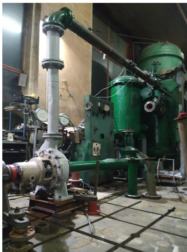
Рисунок 7.1 – Конструкція випробувального стенда: а – випробувальний насос; б – загальний вигляд
