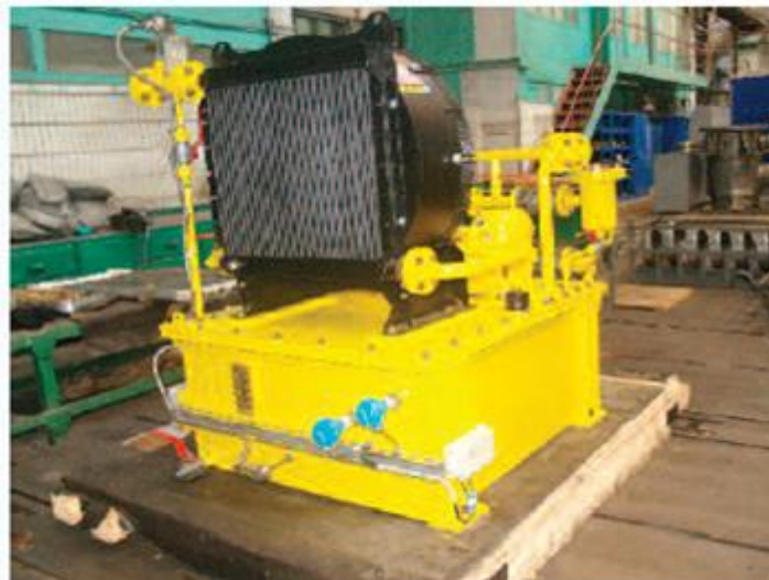
Рисунок 1.9 – Загальний вид маслоустановки
