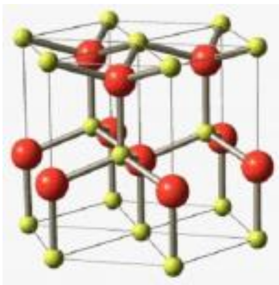
Рис. 1.2 – Елементарна комірка структури оксиду цинку
