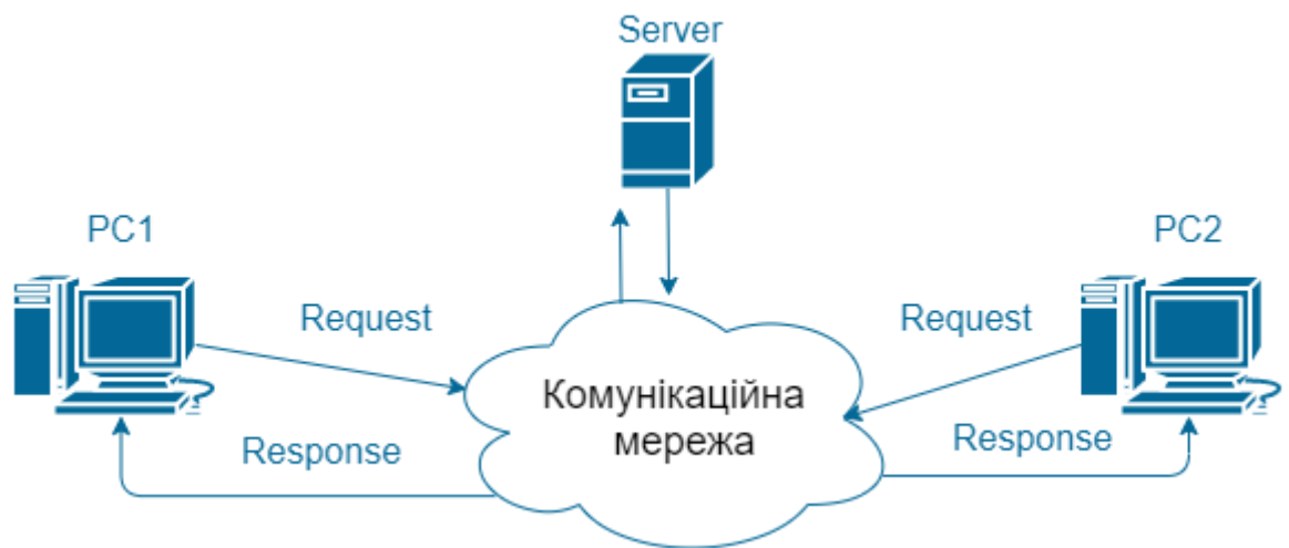
Рисунок 1.10 — Приклад шаблону архітектури «клієнт-сервер»
