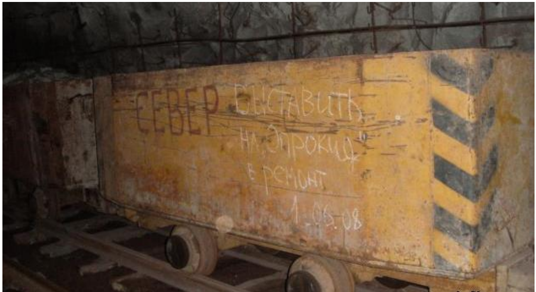
Рис.1.1.2. Фрагмент вагонеток з глухим кузовом, які слідують на розвантаження.
