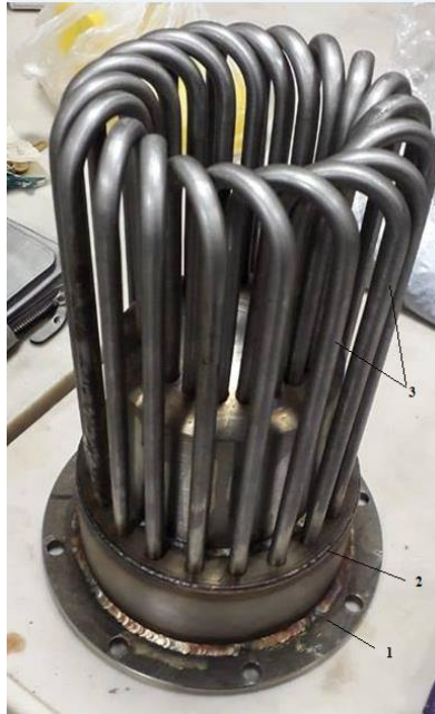
Рисунок 3.1 - Теплообмінник з U - подібними трубками: (1 - кришка; 2 - корпус; 3 - U- подібні трубки)
