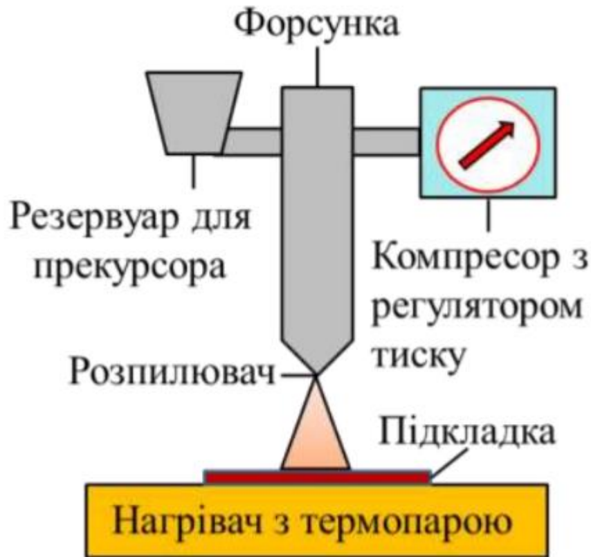
Рисунок 2.1 – Блок-схема осадження методом спреї-піролізу
