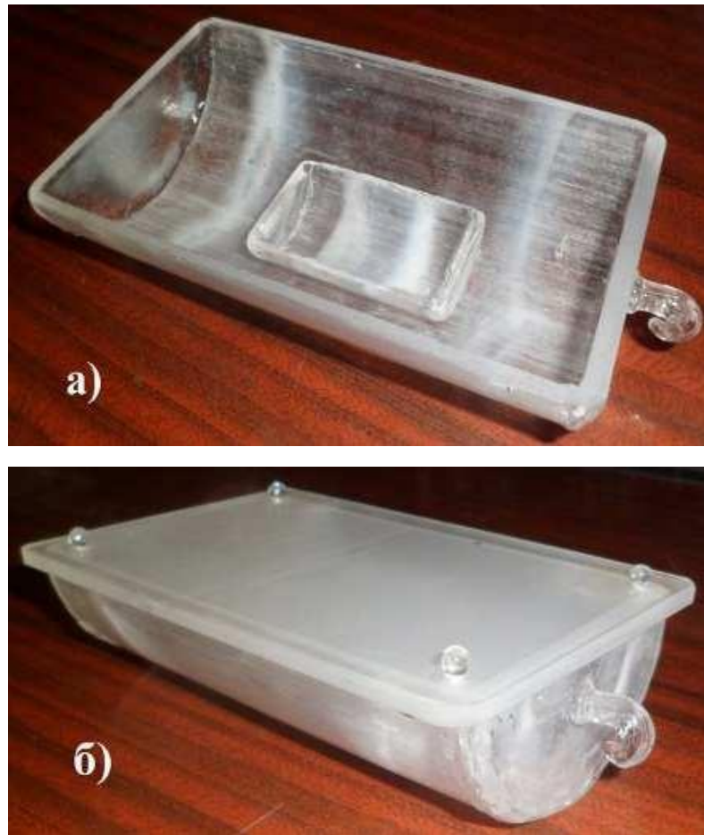
Рис. 4.3 Кварцовий реактор з кварцовим тиглем у відкритому (а) та закритому (б) вигляді.
