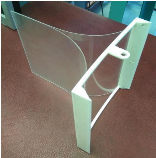
Рисунок 2.8 – Експериментальний стенд для дослідження аерогідропружної взаємодії газорідного потоку та пружних відбійних елементів динамічних сепараційних пристроїв.
