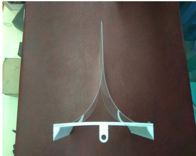
Рисунок 2.8 – Експериментальний стенд для дослідження аерогідропружної взаємодії газорідного потоку та пружних відбійних елементів динамічних сепараційних пристроїв.
