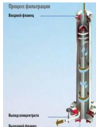
Рисунок 2.1 - Схема SPR-сепаратору з основними потоками
