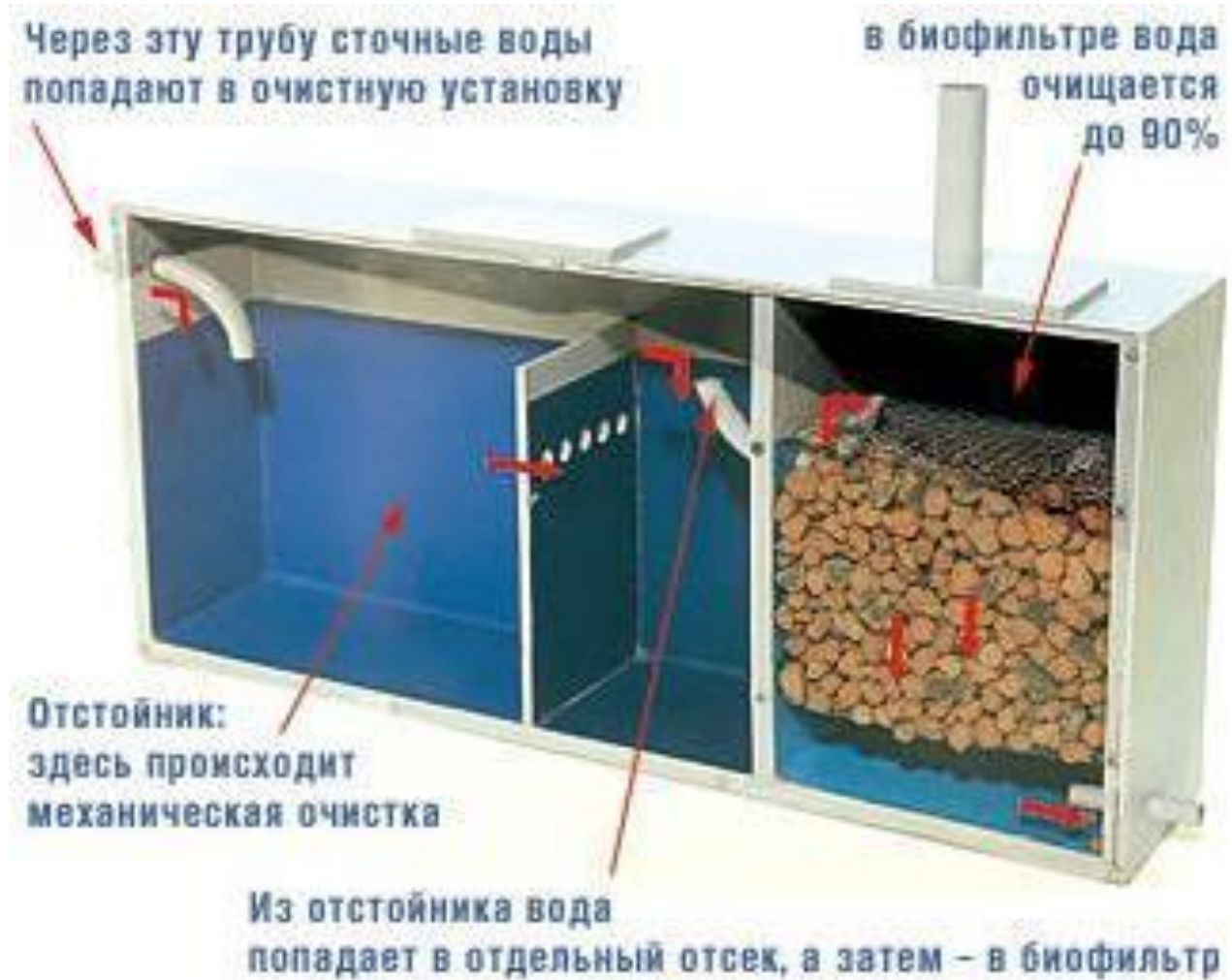
Рисунок 2.9 – Поперечний розріз біофільтра
