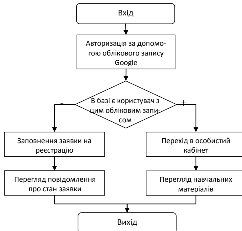
Рисунок 3.5 – Блок-схема, що зображує еталонну послідовність дій користувача
